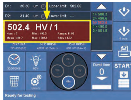
Misurazione fuori dai limiti di tolleranza
