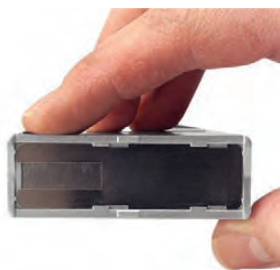
Protezione integrata del tastatore in posizione chiusa
