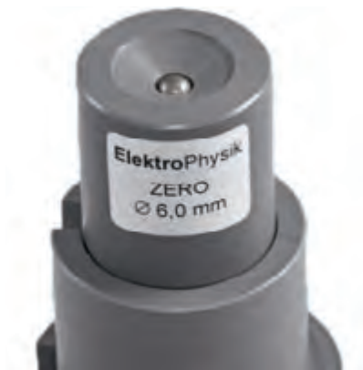
Standard di azzeramento per sfere Ø 6,0 mm
