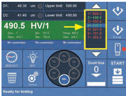
Panoramica delle misurazioni effettuate
