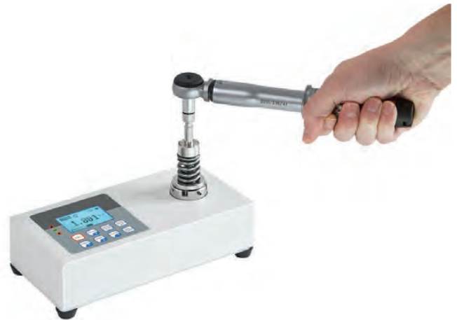
Controllo della coppia di forze di chiave dinamometrica
