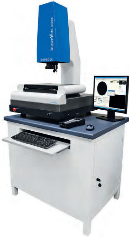
InspecVista 3020A ottica + tastatore TP 20 + supporto
