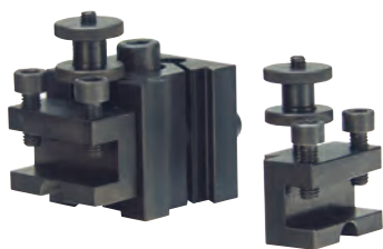
In dotazione una torretta portautensili multipla con 2 inserti.
