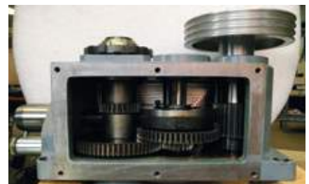
Scatola ingranaggi in bagno d'olio.
