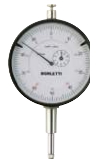
SC60ANT Comparatore centesimale corsa 10 mm
