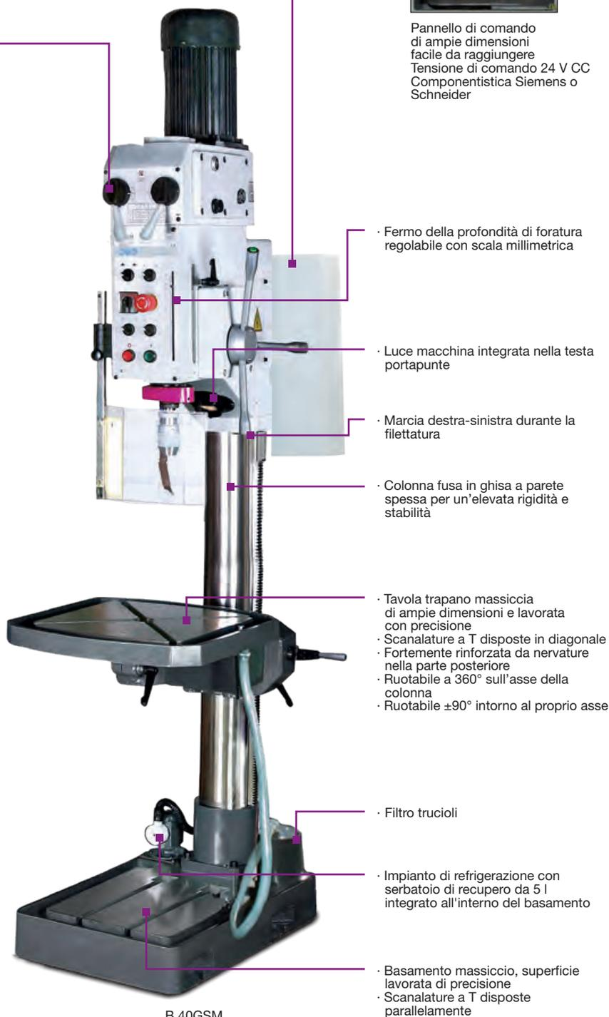
· Fermo della profondità di foratura regolabile con scala millimetrica
