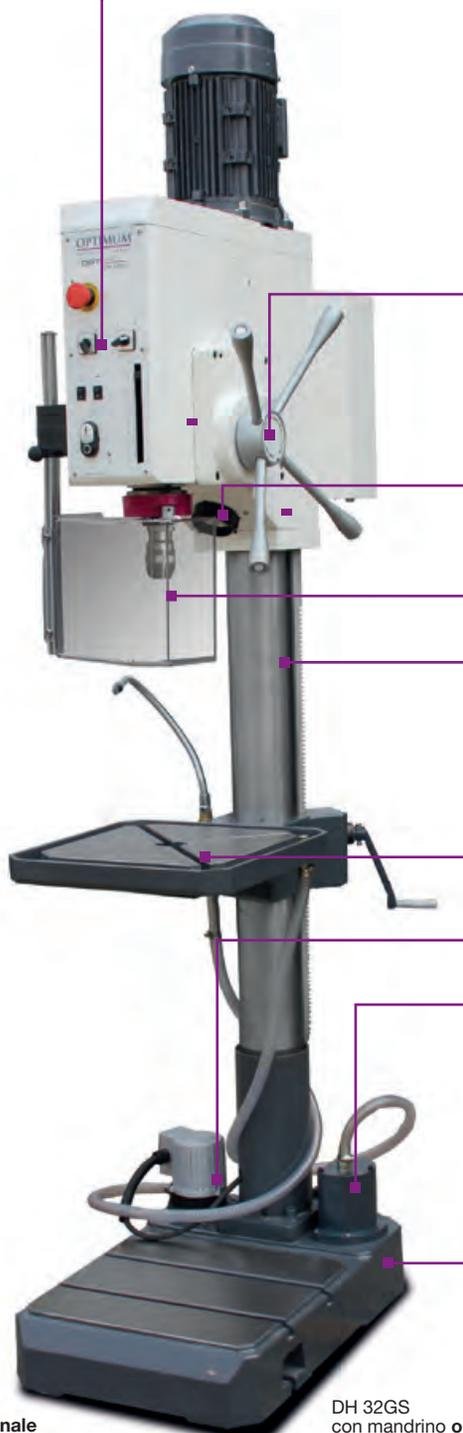
· Per cicli di foratura profonda o per fori ciechi, l'innesto per l'avanzamento automatico del canotto può essere inserito/disinserito in ogni momento azionando il pulsante posto sull'impugnatura anteriore
