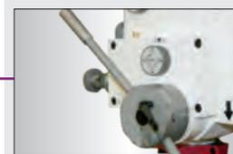
Per cicli di foratura profonda o per fori ciechi, l'innesto per l'avanzamento automatico del cannotto può essere inserito/disinserito in ogni momento azionando la leva di discesa
