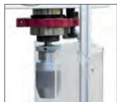
· Cambio utensile facilitato tramite espulsore integrato
