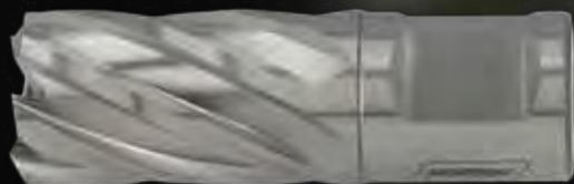
Le frese a tazza Norton si utilizzano con trapani magnetici o con macchine perforatrici. Funzionano in modo diverso rispetto alle tradizionali punte elicoidali, in quanto tagliano solo lungo la periferia del foro, lasciando un dischetto di materiale al centro che viene espulso dal perno centrale di centraggio. Questo consente di eseguire più facilmente e velocemente fori più grandi e di prolungare la durata dell'utensile.
