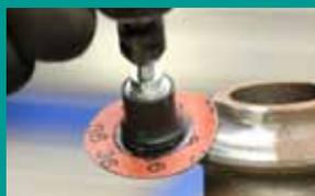
Evitare l'uso del dischetto su forme complesse utilizzando un platello piccolo (ad es. 38 mm con diametro disco 50 mm) perchè si rischia di rovinare il supporto.
