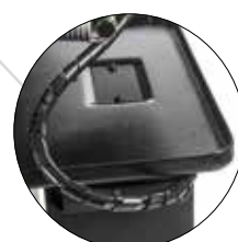
Serbatoio di raccolta refrigerante
