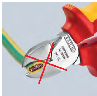
Taglio del cavo con tronchese laterale: sforzo elevato, taglio impreciso, elevata deformazione e schiacciamento del cavo
