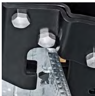
Il punzone viene premuto attraverso i profili in lamiera
