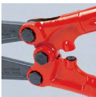
Battuta forgiata con inserto ammortizzato: ammortizza in modo efficace l'impatto di taglio
