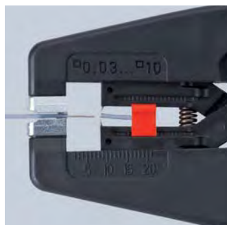
Spelatura precisa di sezioni da 0,03 a 10 mm 2 in una sola volta
