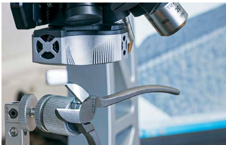
Nel tronchese laterale, la forma e la ruvidità del tagliente vengono misurate in modo preciso con un sistema di misura ottico 3D.
