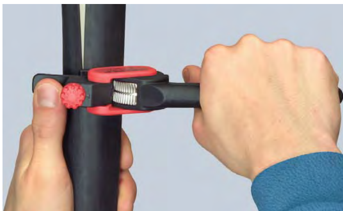
Rotazione dell'utensile per taglio circolare
