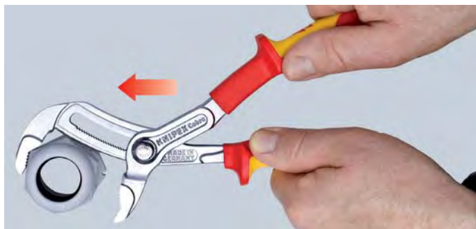
Regolazione rapida sul pezzo senza premere il pulsante
