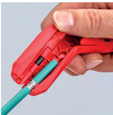
Sguainatura di un cavo per trasmissione dati
