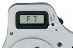
Indicatore digitale multifunzione, impostazione in mm, pollici o altre modalità MIL
