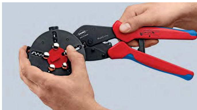
Sostituzione matrice di crimpaggio: sbloccare il fermo della matrice sul supporto e successivamente rimuovere la matrice
