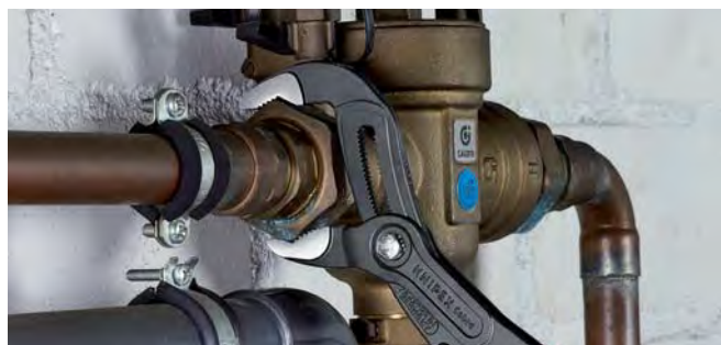
I denti contrari al senso di rotazione provocano un effetto autoserrante ed impediscono lo scivolamento sul pezzo.
