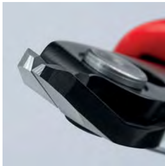
Sezione di taglio con micro-spostamento dei taglienti controllato per un taglio ultrapreciso anche dei fili metallici più sottili e per una lunga durata
