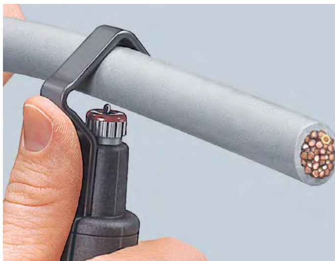
Posizionamento dell'utensile per taglio perimetrale
