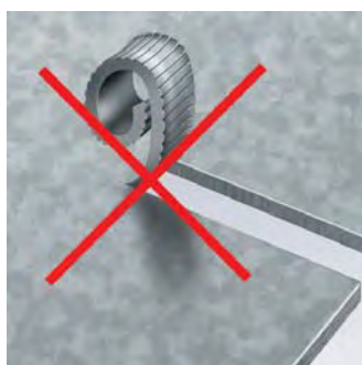
Intaglio senza rottura del truciolo
