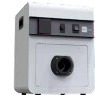
Unità di aspirazione mobile adatta all'impiego nel laboratorio odontotecnico per l'aspirazione delle polveri di lavorazione e dei residui abrasivi. Collegabile a sabbiatrici, lucidatrici, fresatrici, micromotori, ed utilizzabile con i banchi da laboratorio. Sistema di filtraggio a 3 stadi (sacco in microfibra, filtro a cartuccia classe M, filtro uscita HEPA) Elettronica EMC e presa elettroutensile con sistema di avviamento e spegnimento automatico.
