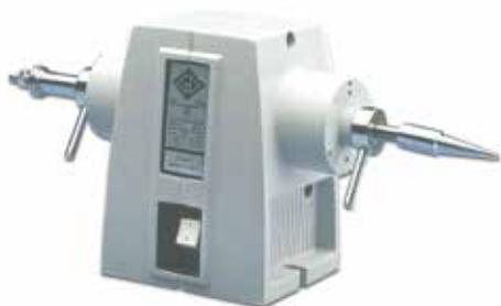
Pulitrice per lavoro continuo LUX-1 ad una velocità (2.800 g/m) 300 Watt.
