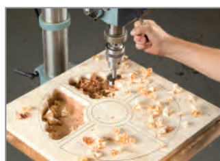
Passate l'interno del vassoio con una punta Forstner da 50,8mm in un trapano a colonna.
