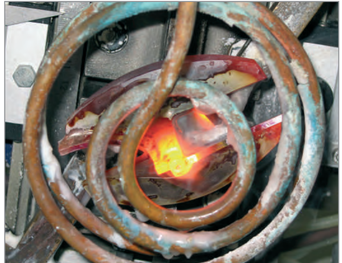
Saldatura a 680°C in pochi secondi.
