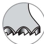
DENTATURA ONDULATA UNIVERSALE
