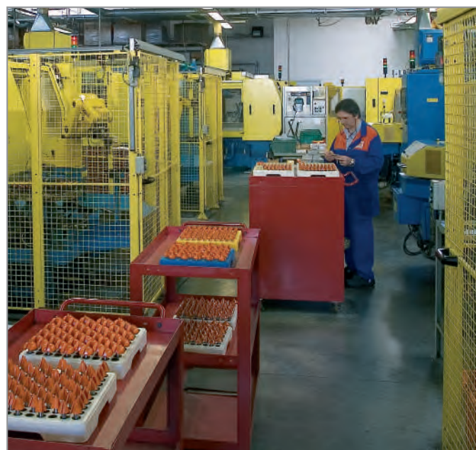
Affilatura multiasse a CNC robotizzata.
