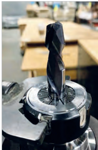
Fresa con rivestimento DLCS
