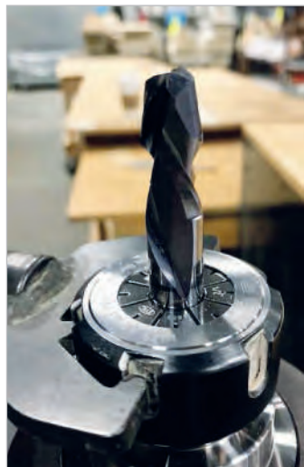
Fresa con rivestimento DLCS
