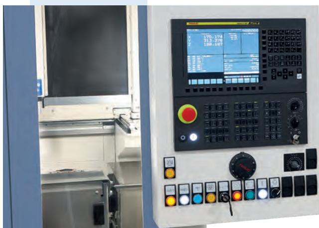
Equipaggiamento hardware e software Fanuc, per la lavorazione di superfici ad alta velocità. Segnalatore acustico ed avvisatore telefonico per segnalazione allarmi macchina su lavorazioni non presidiate.
