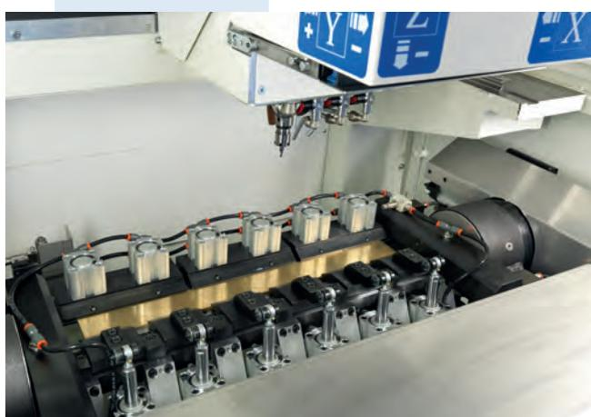
Elettromandrino ad alta velocità dotato di dispositivo per maschiatura rigida. Robusta tavola ribaltabile con sistema pneumatico. Morsa di serraggio barre progettata per massima rapidità di cambio formato.
