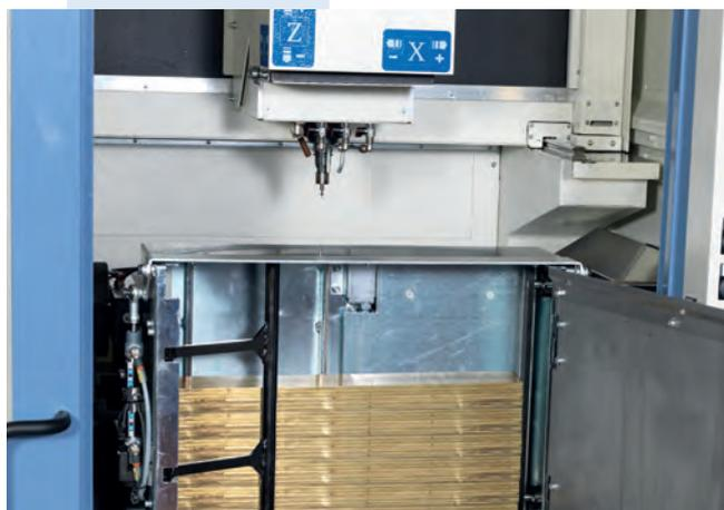
Magazzino barre interno alla macchina con sistema di prelievo a ventosa per ridurre al minimo i tempi di ciclo. Il magazzino è dotato di un sistema di misurazione spessore barre per la gestione automatica dei multiprogrammi.
